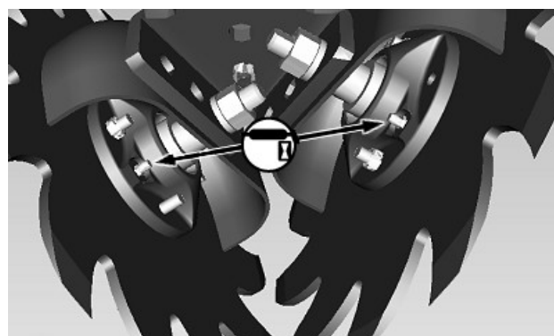
Cubo de limpiador de hilera montado en la unidad (vista inferior)
