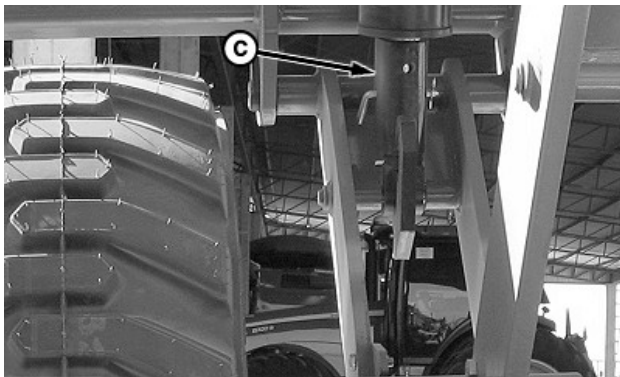
Bloqueos de mantenimiento de las ruedas de secciones laterales
