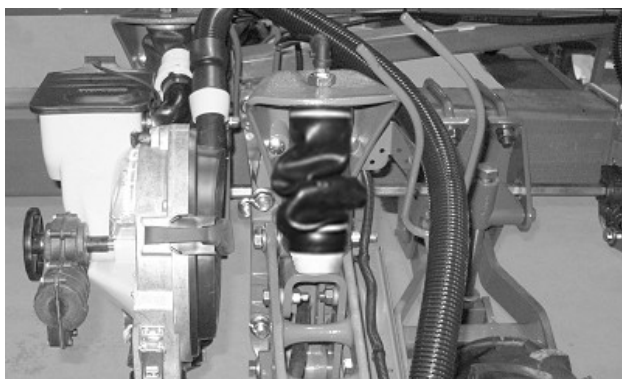
Muelle neumático enrollado en forma incorrecta (sembradoras de hileras dobles)
