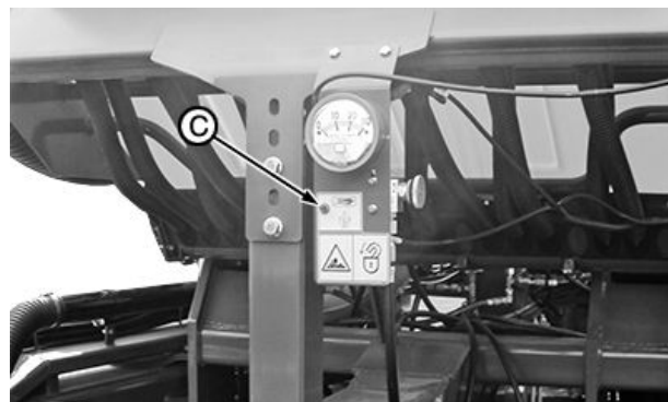
Interruptor del ventilador del CCS
