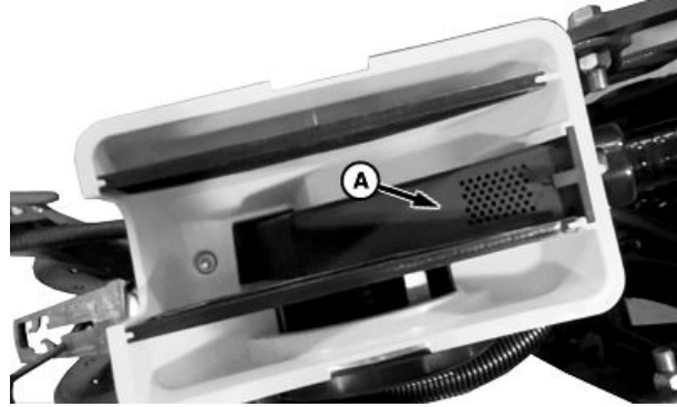
A—Entrada de la tolva
