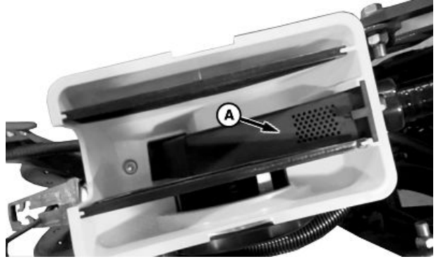
A—Entrada de la tolva
