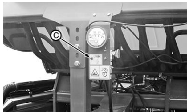
Interruptor del ventilador del CCS
