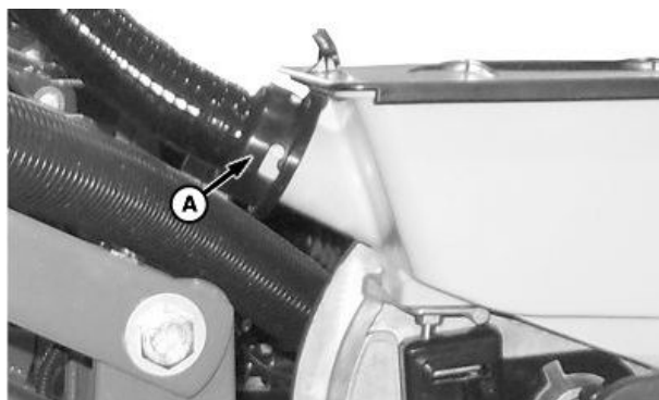
A—Mangueras de distribución de semillas
