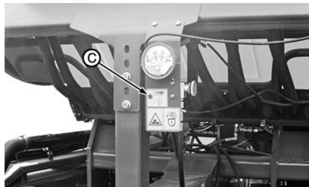
Interruptor do ventilador do CCS
