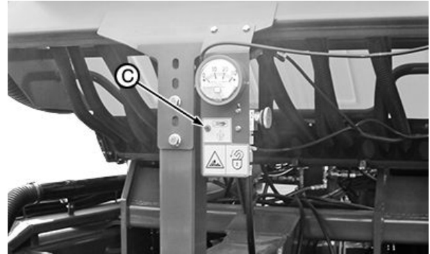
Interruptor do ventilador do CCS
