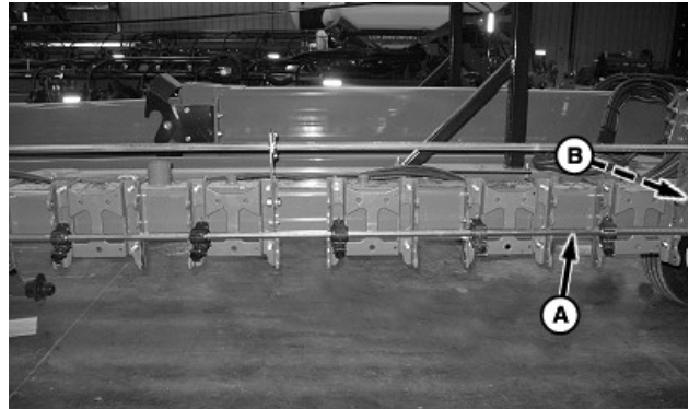
A—Arborele de acționare a semănătorii 437 cm (172 in) B—Rândul 10
