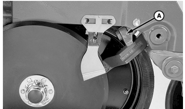
A—Instrument atașat cu roți mobile de control al adâncimii
