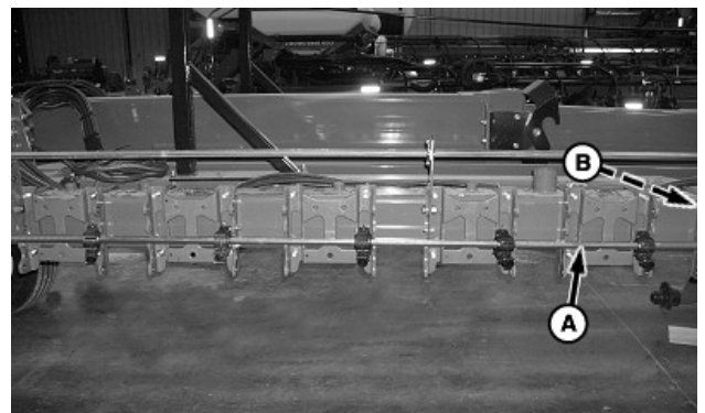
Arborele de acționare a semănătorii 437 cm (172 in) (aripe dreaptă)
