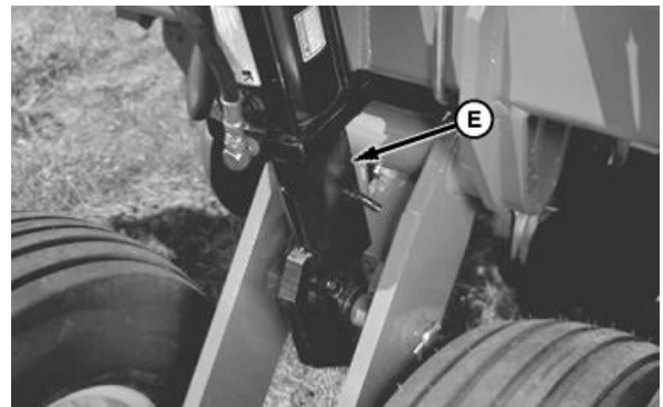
Вспомогательные фиксаторы колеса крыла
