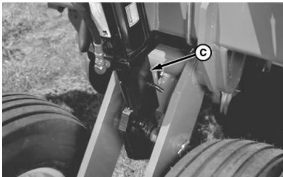
Вспомогательные фиксаторы колес крыла
