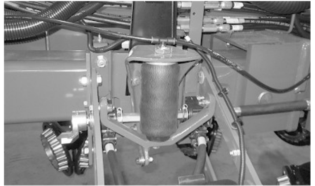
Mola Pneumática Devidamente Enrolada Sobre o Suporte Inferior
