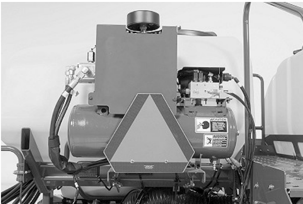
A72531—UN—12SEP11 Válvula Solenoide de Controle, Tanque de Ar e Compressor de Ar da Força Descendente Pneumática - Plantadeiras Rebocadas com CCS™ (Força Descendente Ativa)
