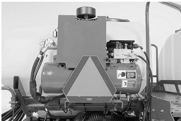
A72531—UN—12SEP11 Сиқувчи куч пневматик ҳаво компрессори, ҳаво баки ва соленоид назорат клапани - CCS™ тизимли тўлиқ тортилган сеялка (фаол сиқувчи куч)
