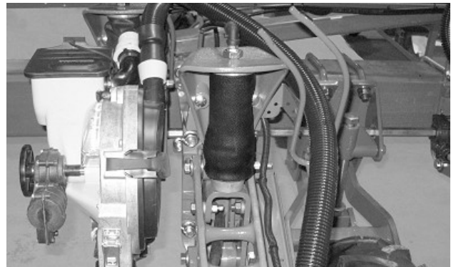
Ressort pneumatique correctement enroulé (semelles à rangs jumelés)
