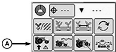
A72767—UN—23SEP11 Bouton Pression vers le bas (pression pneumatique vers le bas à un capteur)
