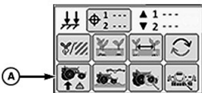
A72740—UN—23SEP11 Bouton Pression vers le bas (pression pneumatique vers le bas à point de consigne double)
