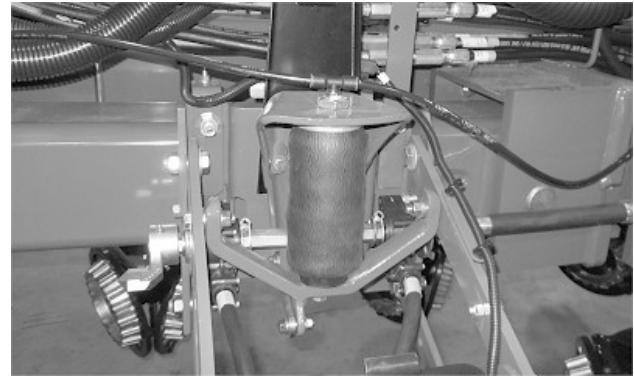
Ressort pneumatique correctement enroulé sur le montage inférieur
