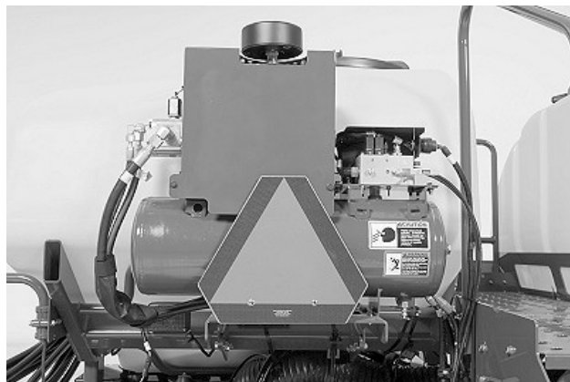
A72531—UN—12SEP11 Пневматикалық басу күшінің ауа компрессоры, ауа бағы және соленоидты басқару клапаны - CCS
