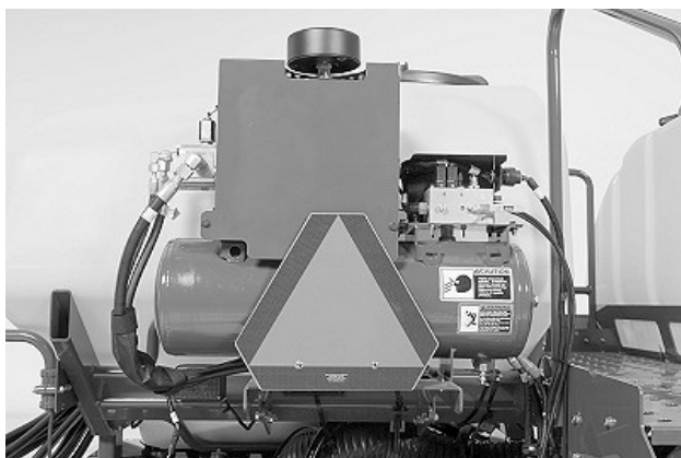
A72531—UN—12SEP11 Пневматикалық басу күшінің ауа компрессоры, ауа бағы және соленоидты басқару клапаны - ОӨЖ бар сүйрелетін сепкіштер (Белсенді басу күші)
