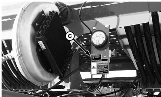
Переключатель вентилятора системы центрального распределения (CCS)
