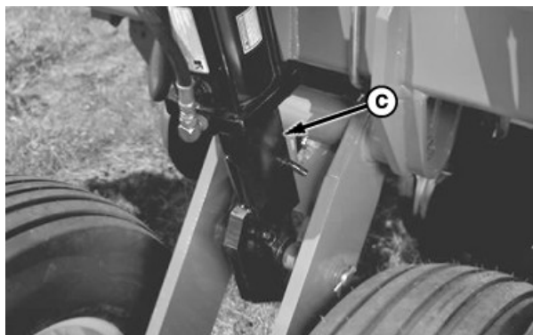
Вспомогательные фиксаторы колес крыла
