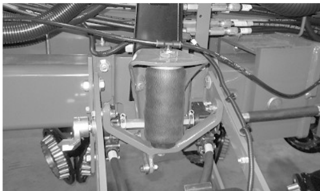
Правильно расправленная пневмопружина на нижнем креплении
