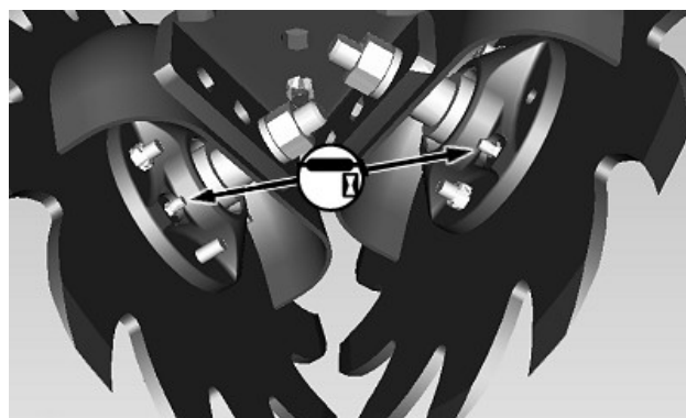
Ступицы очистителей рядков, монтируемые на высевающей секции (вид сверху)
