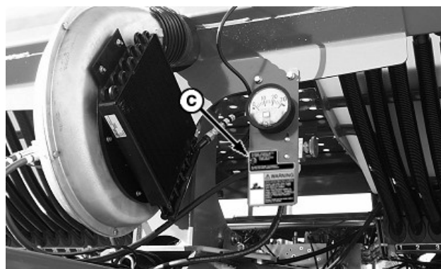
Переключатель вентилятора системы центрального распределения (CCS)
