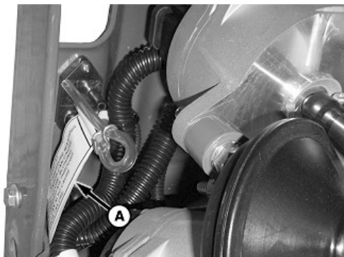
A—Adhesivo, sensor de vacío
