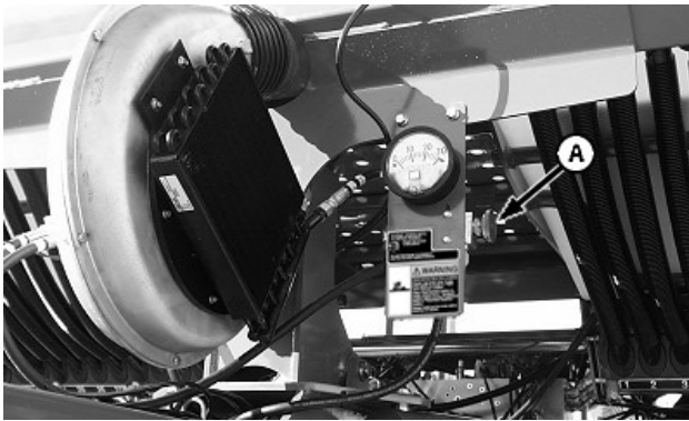
A—Palanca de la válvula reguladora de caudal
