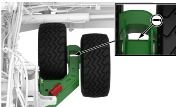
Balancín tándem del bastidor central
