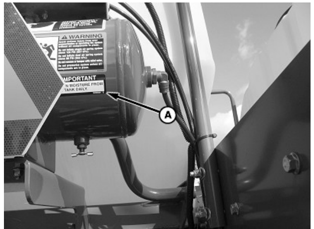
A—Adhesivo, vaciado del depósito de aire
