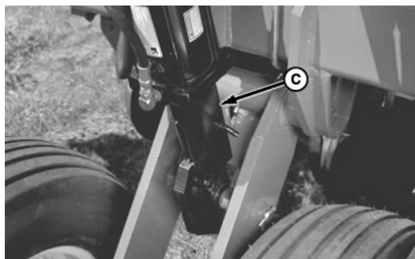
Bloqueos de mantenimiento de ruedas de secciones laterales
