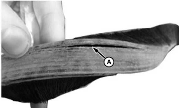
A77776—UN—13DEC13 Daños en la abertura de junta
