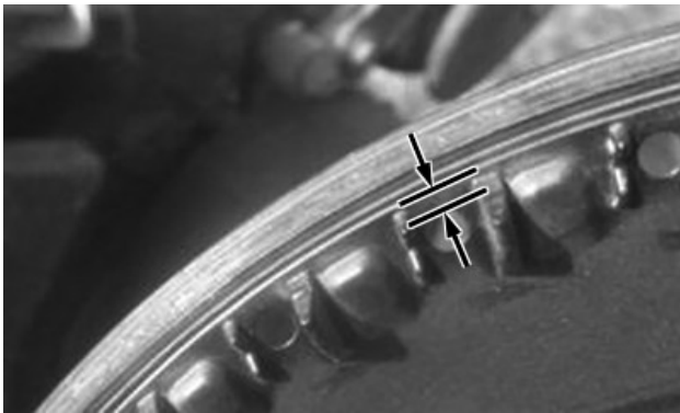
Discos de semillas parcialmente desgastados (tazón)
