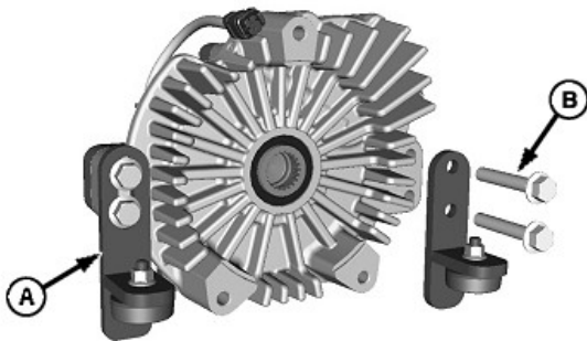
A—Soporte del calzo (se usan 2) B—Tornillo M12 x 70 (se usan 4)
