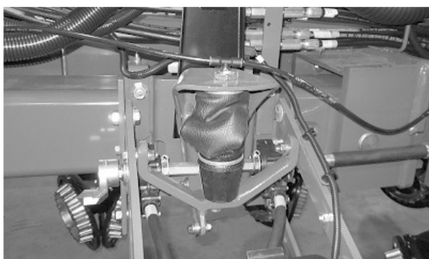
Muelle neumático enrollado incorrectamente
