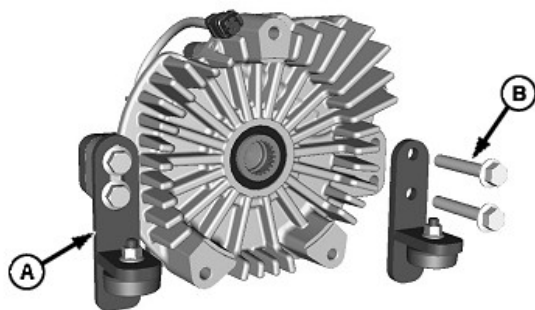
A—Soporte de calzo (se usan dos) B—Tornillo de brida, M12 x 70 (se usan 4)
