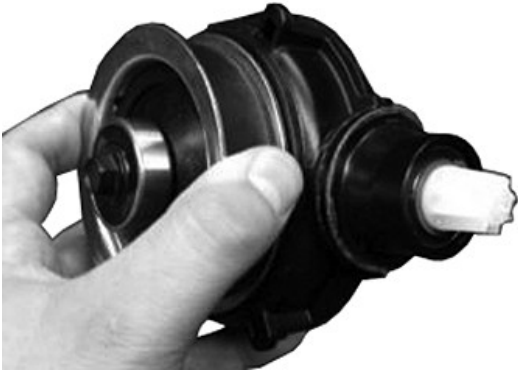
A100142—UN—21MAR18 Caja de engranajes del BrushBelt™
