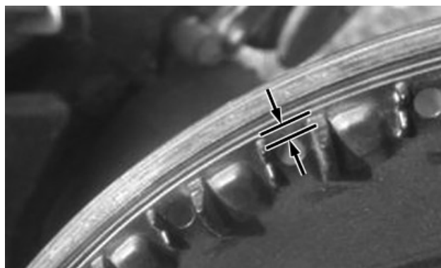
Discos de semillas parcialmente desgastados (tazón)
