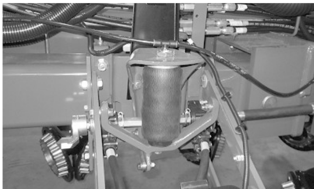
Muelle neumático enrollado correctamente
