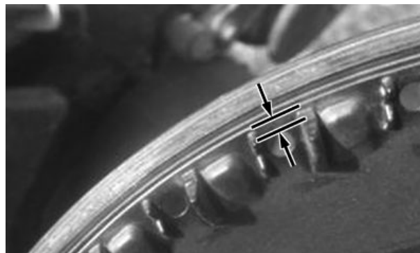
Discos de semillas parcialmente desgastados (tazón)
