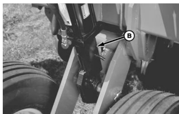
Bloqueos de mantenimiento de las ruedas de secciones laterales
