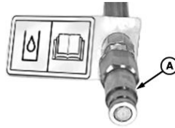
Vaciado de caja conectado primero
