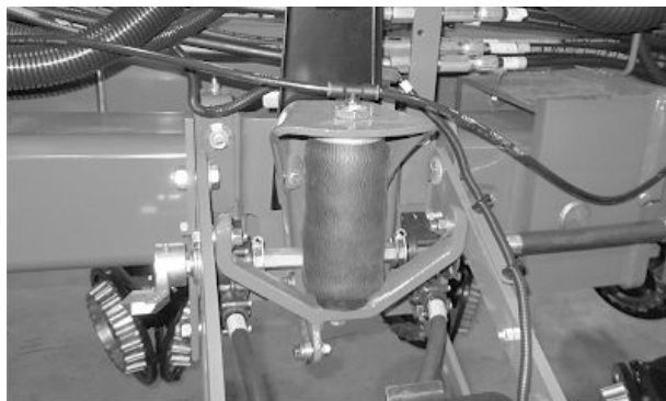
Muelle neumático enrollado correctamente
