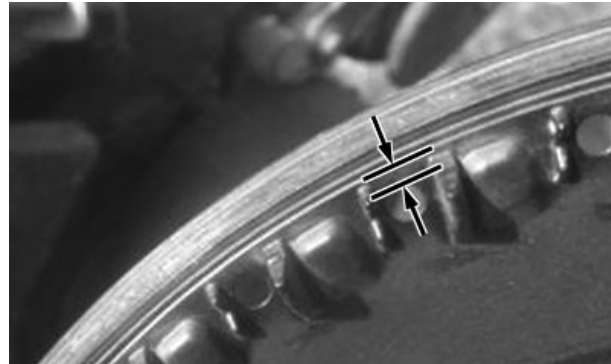
Disque de doseur à semences partiellement usé (cuvette)
