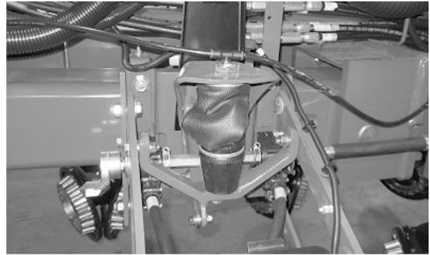
Ressort pneumatique mal enroulé
