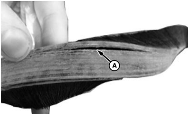
Détérioration de type rupture
