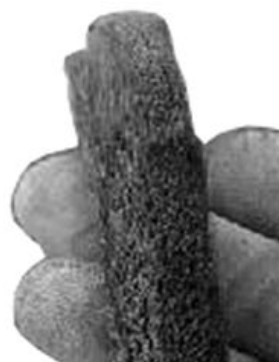
Usure latérale irrégulière
