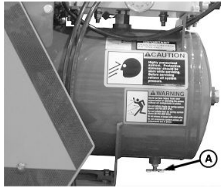
Soupape de vidange du réservoir d'air de pression vers le bas
