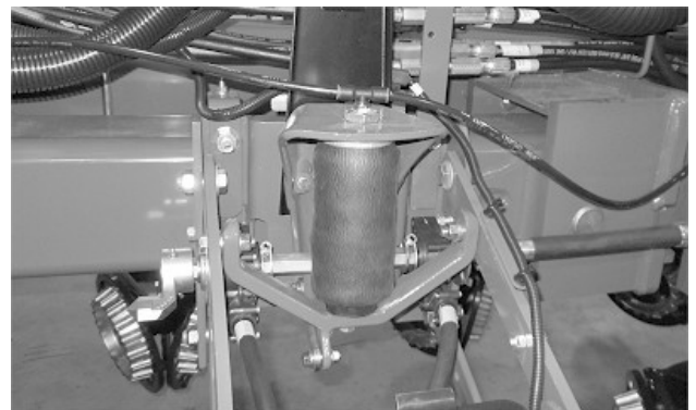
Ауа серіппесі төменгі тірекке дұрыс оралған
