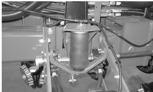
Правильно скрученная пневмопружина
