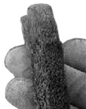
Неравномерный поперечный износ
