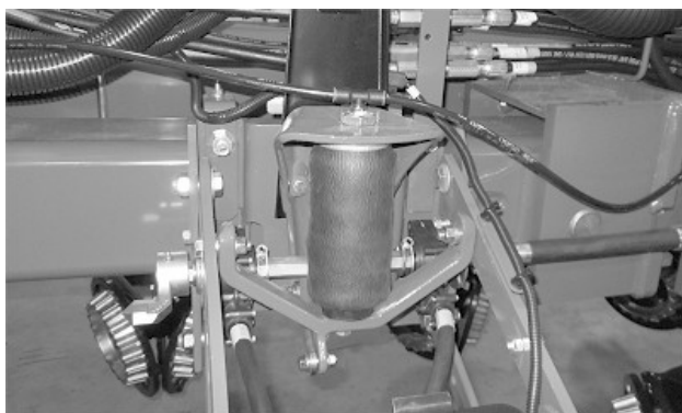
Правильно расправленная пневмопружина
