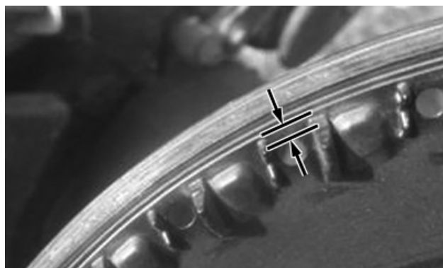
Частично изношенный высевальной диск (чаша)
