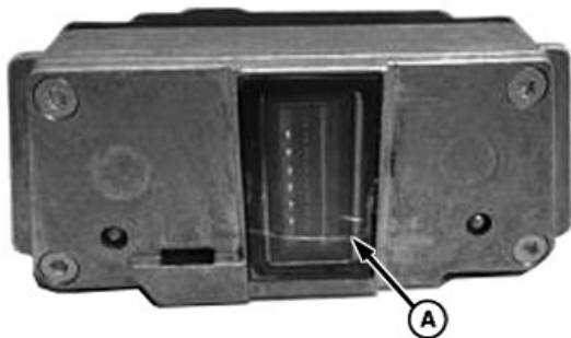
Датчик заполнения семенного ящика
