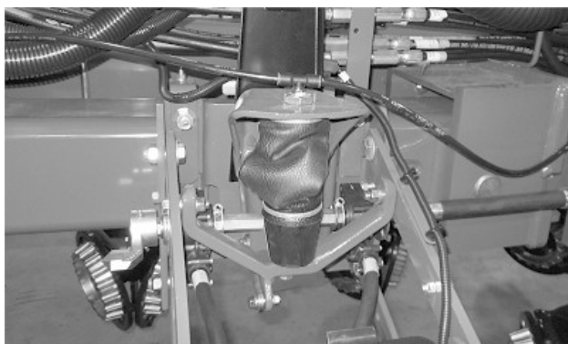
Неправильно скрученная пневматическая пружина
