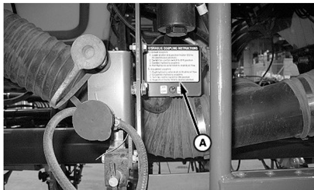
A—Гидравлические муфты вспомогательного оборудования
