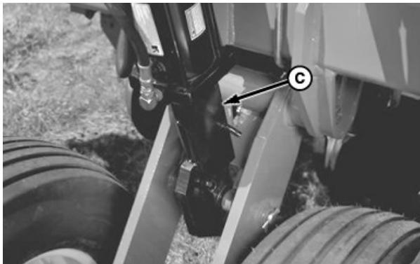
Вспомогательные фиксаторы колес крыла
