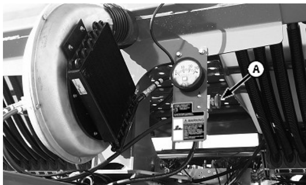
А—Рукоятка клапана регулирования расхода
