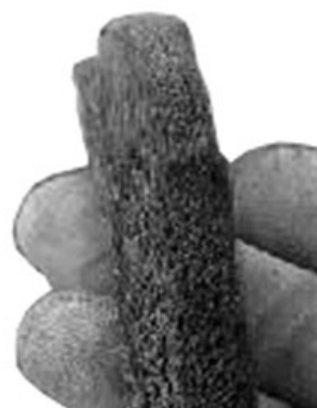
Неравномерный поперечный износ
