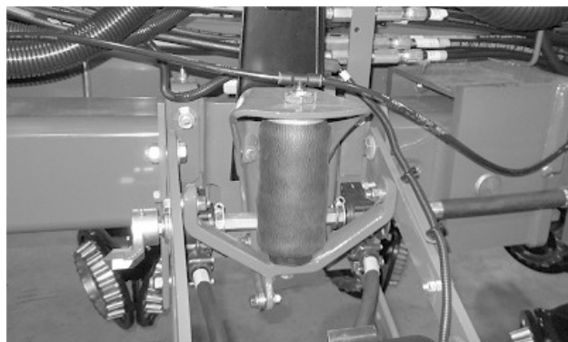
Правильно скрученная пневмопружина
