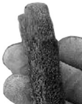
A100144—UN—21MAR18 Uzură asimetrică între laturi
