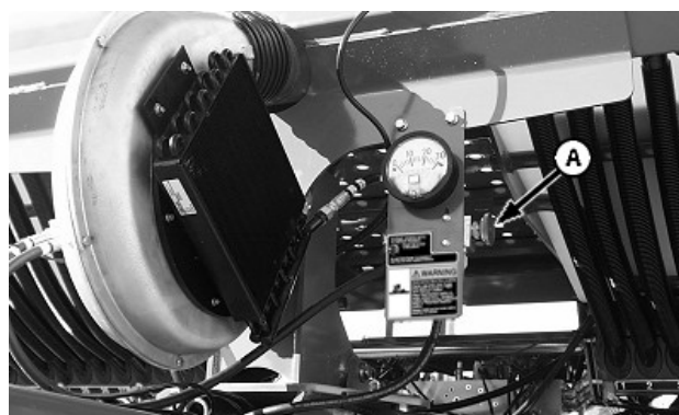
A—Клапан регулювання витрати
