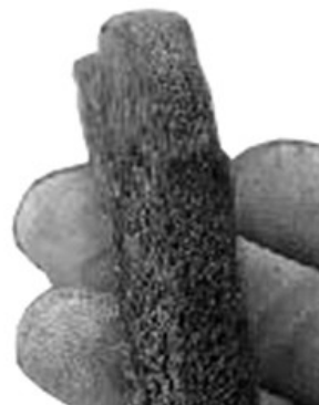
Неравномерный поперечный износ
