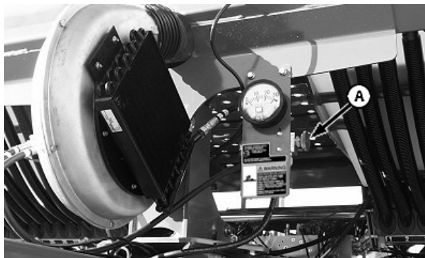
A—Клапан регулирования расхода
