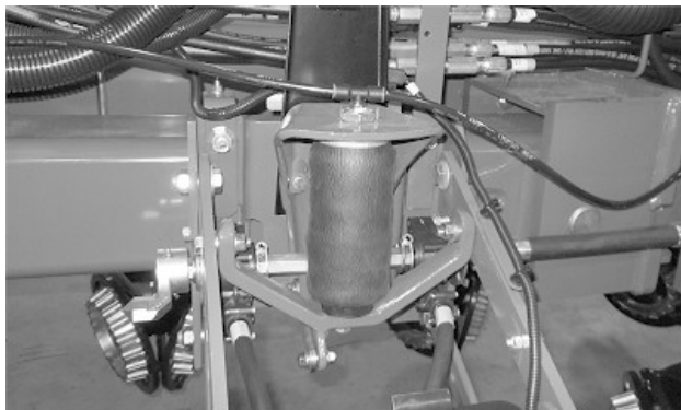
Правильно скрученная пневмопружина
