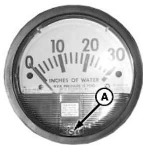
A—Регулировочный винт обнуления
