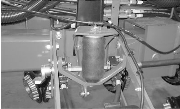
Правильно расправленная пневматическая пружина
