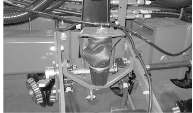
Неправильно расправленная пневматическая пружина
