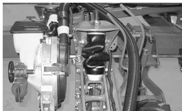
Неправильно расправленная пневматическая пружина (сеялки двухрядного посева)
