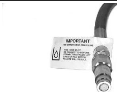
Алдыңғы корпусың төгу құбырының шлангісін шаю бойынша кеңес
