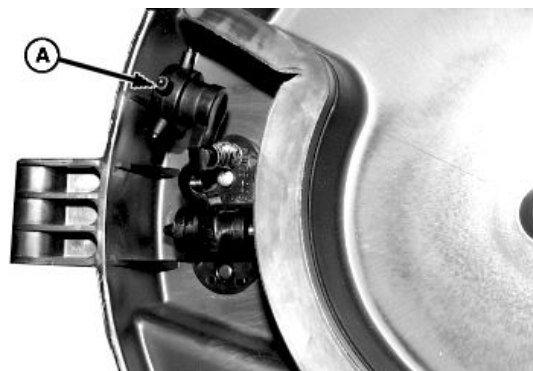
А—Колесико выталкивателя семян
