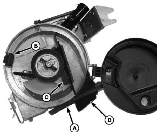
На рисунке показан вакуумный дозатор
