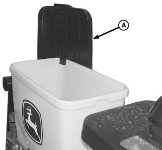
Семенной ящик емкостью 58 л (1,6 бушеля)
