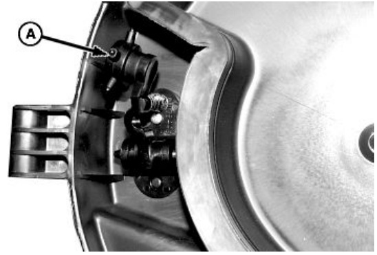
А—Колесико выталкивателя семян
