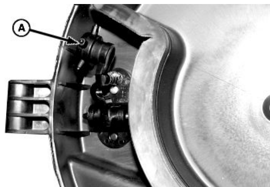
А—Колесико выталкивателя семян
