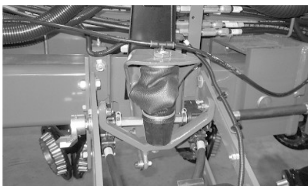
Неправильно скрученная пневмопружина
