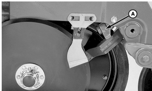
A—Балансирное копирующее колесо (дополнительное оборудование)
