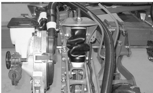
Неправильно расправленная пневматическая пружина (сеялки двухрядного посева)
