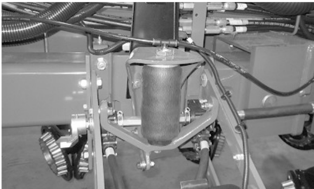
Правильно расправленная пневмопружина на нижнем креплении
