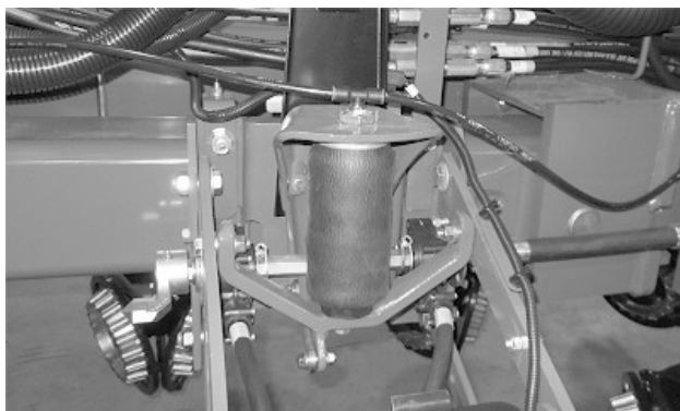
Правильно скрученная пневмопружина
