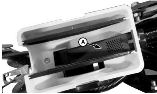
A—Entrada de la tolva
