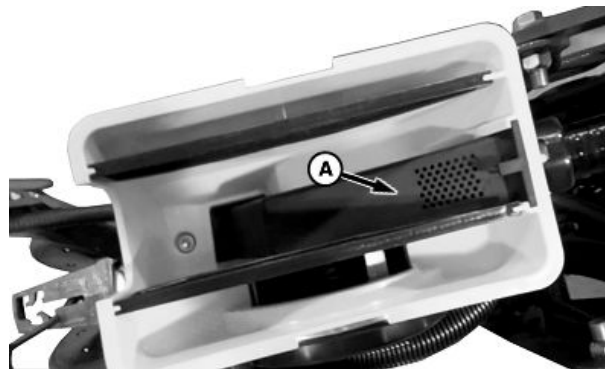
A—Entrada de la tolva
