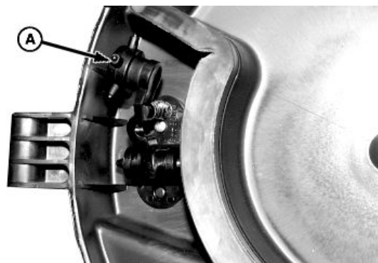
A—Roate de ejectare pentru semințe
