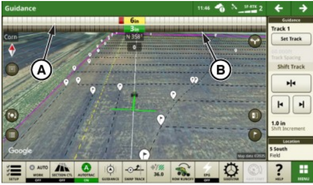
A—แถบไฟสถานะเครื่องจักร B—แถบไฟสถานะต่อพ่วง
