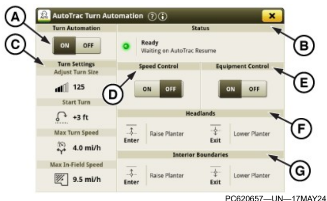
PC620657—UN—17MAY24 Сторінка налаштування системи автоматизації розвороту AutoTrac трактора
