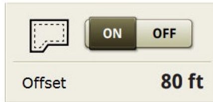
PC28781—UN—25AUG22 Schakelaar Wendakkerregeling en Wendakker-offset
