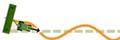
PC28752—UN—25AUG22 Vysoká citlivost vedení při odchýlení ze směru jízdy
