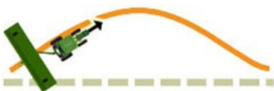
PC28753—UN—25AUG22 Nízká citlivost vedení při odchýlení ze směru jízdy
