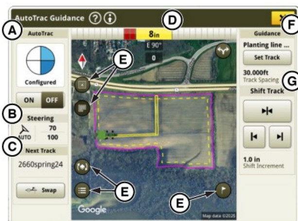
Pagina principale sistema di guida AutoTrac
