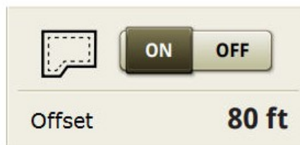
PC28781—UN—25AUG22 Çelësi i kontrollit të fundit të fushës dhe zhvendosja e fundit të fushës
