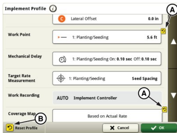
Umístění tlačítka resetování
