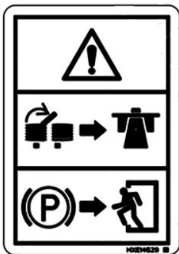
YC11093—UN—13JUN17 23.驻车制动器：驾驶机器上路前，必须将行车制动器锁定在一起。离开机器前，必须结合驻车制动器。
