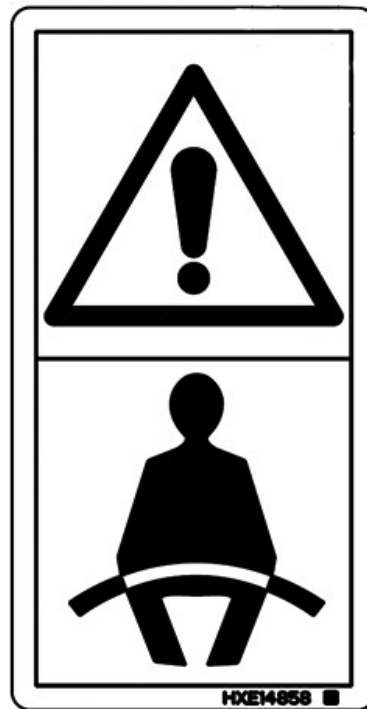
YC11094—UN—13JUN17 24.座椅安全带：操作机器时或作为乘员在车内时，必须系好安全带。
