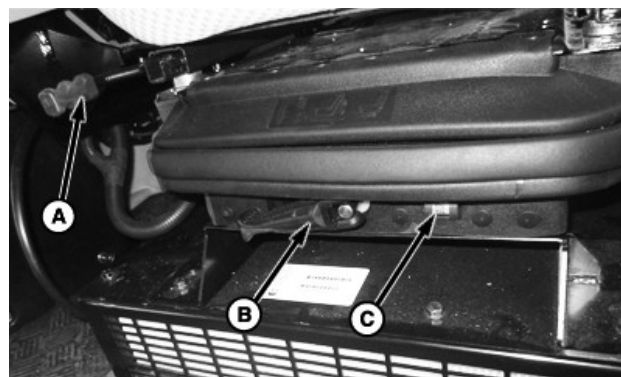
A—前/后调节手柄 B—体重调节手柄 C—体重指示器
