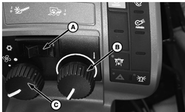
A—空调开关 B—温度控制旋钮 C—风机启动/关闭/转速控制旋钮
