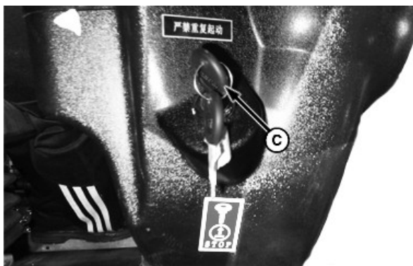
A—手油门开关 B—墨菲表 C—钥匙开关
