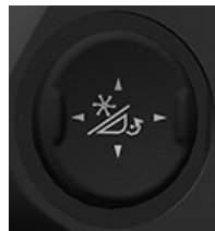
H116349—UN—19DEC16 Contacteur de fonction rabatteur (style B)
