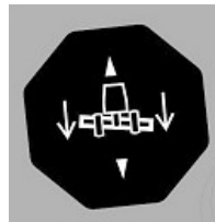
H121090—UN—15MAR17 Contacteur de relevage/ abaissement de l'unité de récolte (style A)
