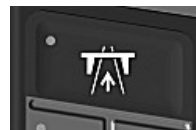
H117022—UN—28MAR16 Роз'єднування для перевезення дорогами (виконання B)
