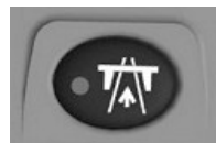
H121089—UN—15MAR17 Роз'єднування для перевезення дорогами (виконання A)
