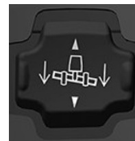
H116348—UN—19DEC16 Skärbordets strömbrytare för höjning/ sänkning (typ B)
