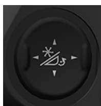
H116349—UN—19DEC16 Contacteur de fonction rabatteur (style B)
