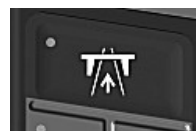
H117022—UN—28MAR16 Interrupteur de sécurité route/champs (style B)
