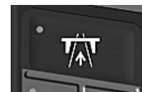
H117022—UN—28MAR16 Переключатель режима дорожного движения (тип B)
