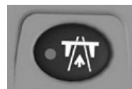
H121089—UN—15MAR17 Переключатель режима дорожного движения (тип A)
