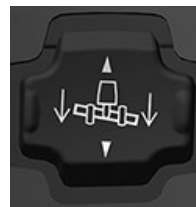
H116348—UN—19DEC16 Przełącznik podnoszenia/ opuszczania hedera (typ B)
