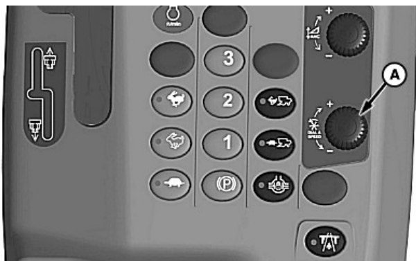
A —Pokrętko automatycznego sterowania prędkością nagarniacza/pasa
