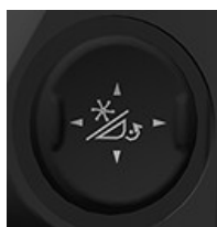
H116349—UN—19DEC16 Przełącznik funkcji nagarniacza (typ B)
