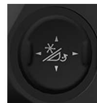
H116349—UN—19DEC16 Przełącznik podnoszenia i przesuwania nagarniacza do przodu/ do tyłu (typ B)
