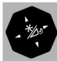
H121181—UN—04APR17 Przełącznik podnoszenia i przesuwania nagarniacza do przodu/ do tyłu (typ A)
