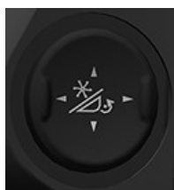
H116349—UN—19DEC16 Functie van de haspelschakelaar (stijl B)
