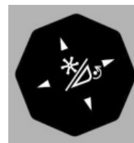
Переключатель подъема и перемещения мотовила вперед/назад (тип A)
