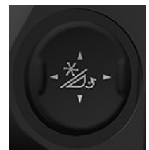
Переключатель подъема и перемещения мотовила вперед/назад (тип B)
