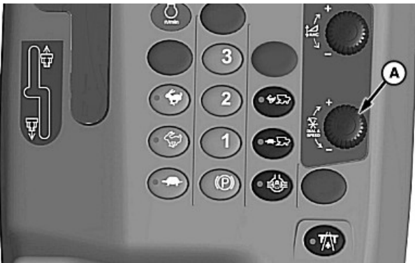
A —Регулятор автоматической скорости мотовила/ленты
