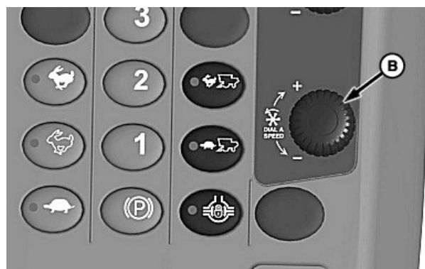
A—Pictogram automatische toerentalverhouding maaikooi/riem B—Instelknop automatische toerentalverhouding maaikooi/riem
