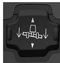
H116348—UN—19DEC16 Schakelaar heffen/ neerlaten maaibord (stijl B)
