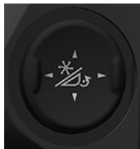
H116349—UN—19DEC16 Kontakt för haspellyft och haspel framåt/bakåt (typ B)
