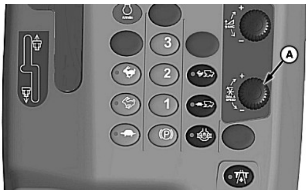
A—Molette de la vitesse du rabatteur/courroie automatique
